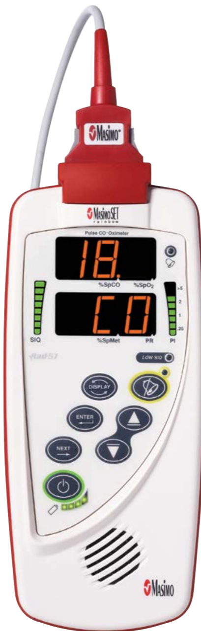
En la imagen se encuentra el Rad-57 que muestra el SpCO. Las características de la pantalla variarían según las mediciones no invasivas cargadas en el dispositivo.
